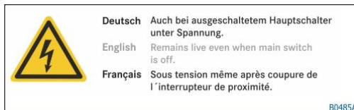
Obr. 2: Výstražná značka „Vypnutý hlavní vypínač“
