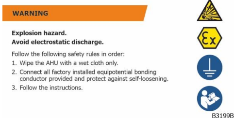
Obr. 7: Výstražná značka: „Nebezpečí výbuchu způsobené elektrostatickým výbojem“
