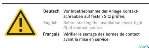
Obr. 4: Výstražná značka „Zkontrolujte kontaktní šrouby“
