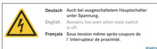
Afb. 2: Waarschuingsbord „Uitgeschakelde hoofdschakelaar“
