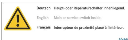
Abb. 3: Warnschild "Haupt- oder Reparaturschalter"
