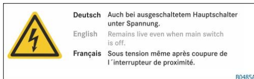
Abb. 2: Warnschild „Ausgeschalteter Hauptschalter“
