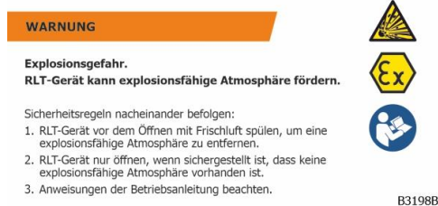
Abb. 6: Warnschild „Explosionsgefahr durch explosionsfähige Atmosphäre“
