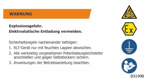
Abb. 7: Warnschild „Explosionsgefahr durch elektrostatische Entladung“
