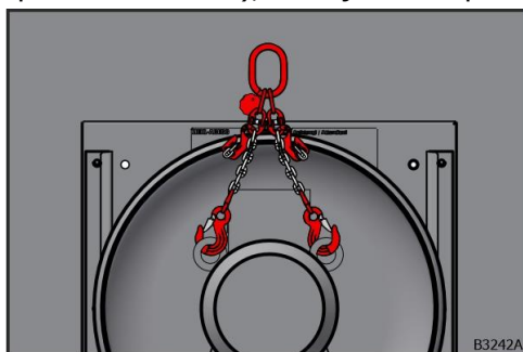
Obr. 83: Zavěšení vázacích řetězů v případě dvou vázacích ok
