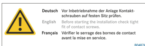
Ilustr. 4: tabliczka ostrzegawcza „Kontrola śrub kontaktowych”
