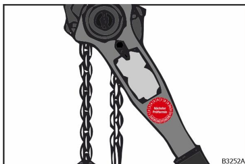
Fig. 108: Etichetă de verificare (palan cu lanț cu manetă)
