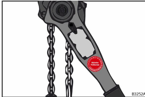
Fig. 51: Etichetă de verificare (palan cu lanț cu manetă)
