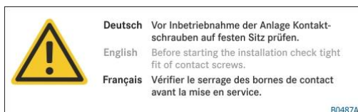
Fig. 4 : Panneau d'avertissement « Vérifier les bornes de contact »
