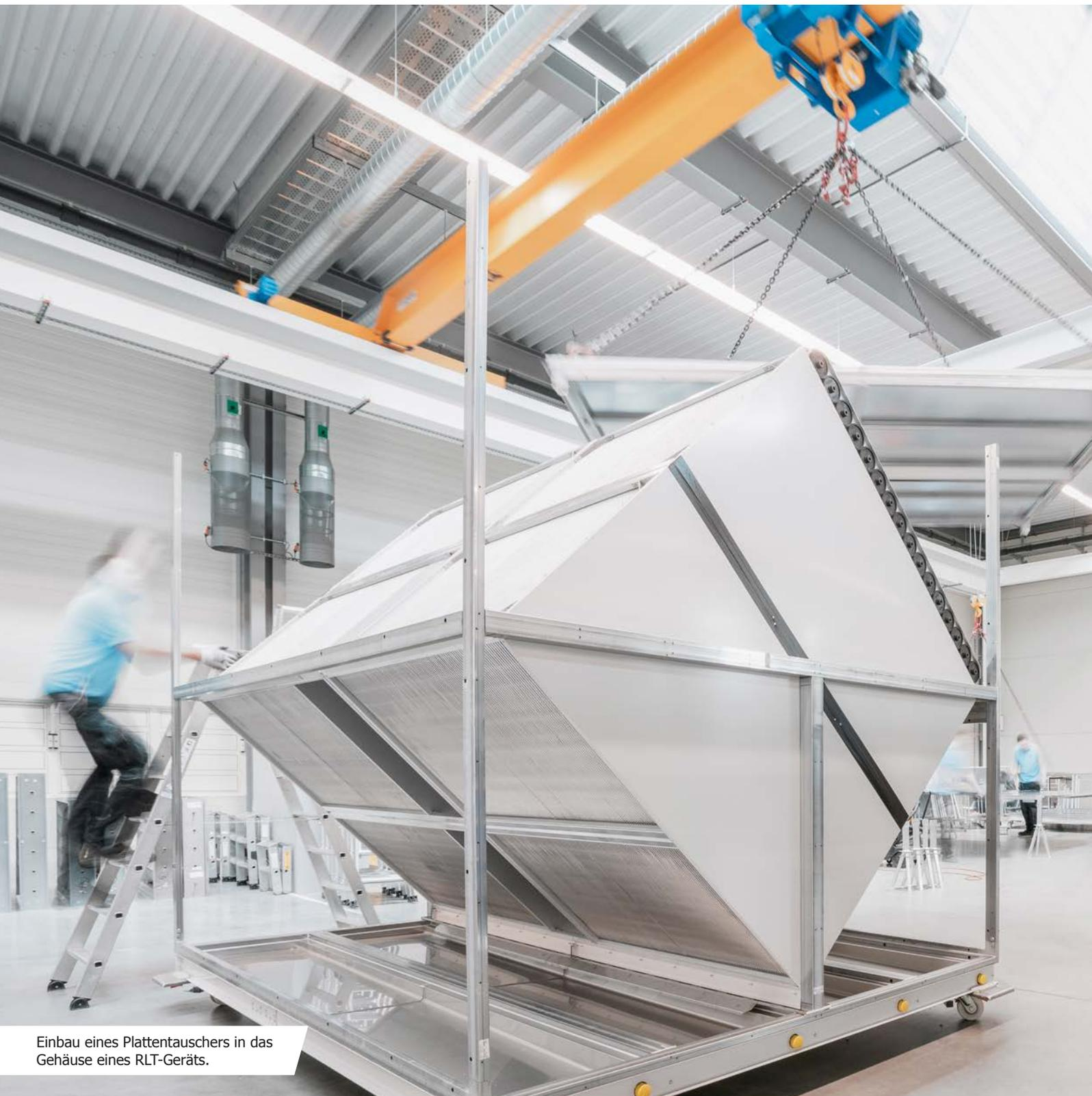
Einbau eines Plattentauschers in das Gehäuse eines RLT-Geräts.
