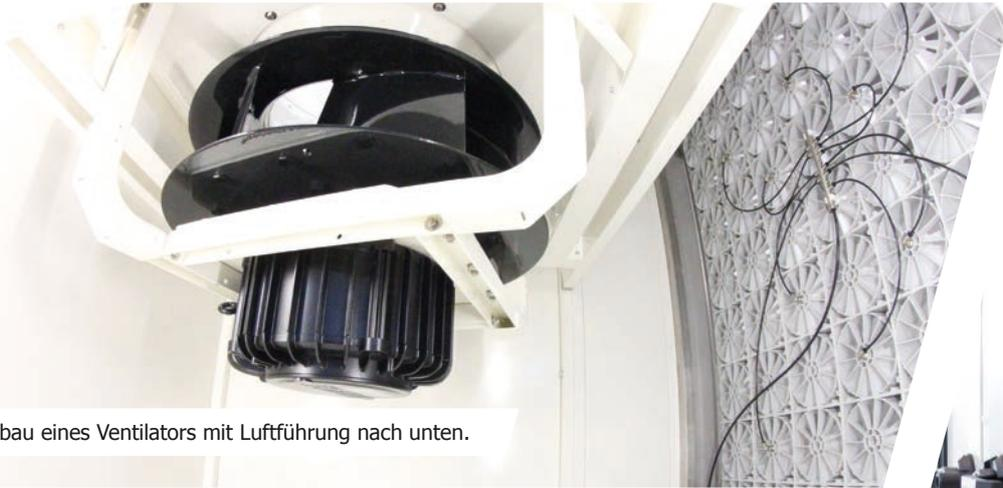
Vertikaler Einbau eines Ventilators mit Luftführung nach unten.
