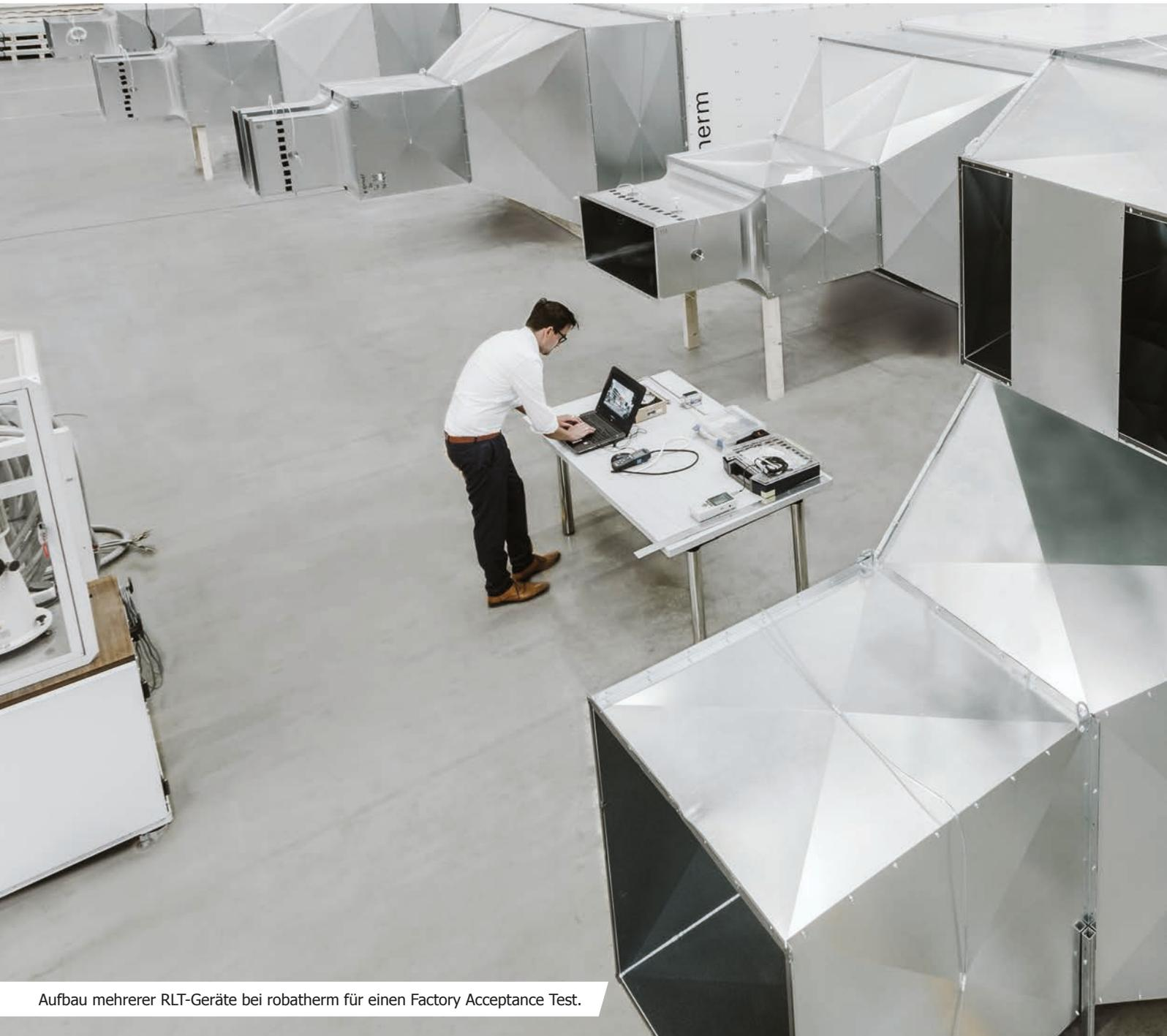
Aufbau mehrerer RLT-Geräte bei robatherm für einen Factory Acceptance Test.
