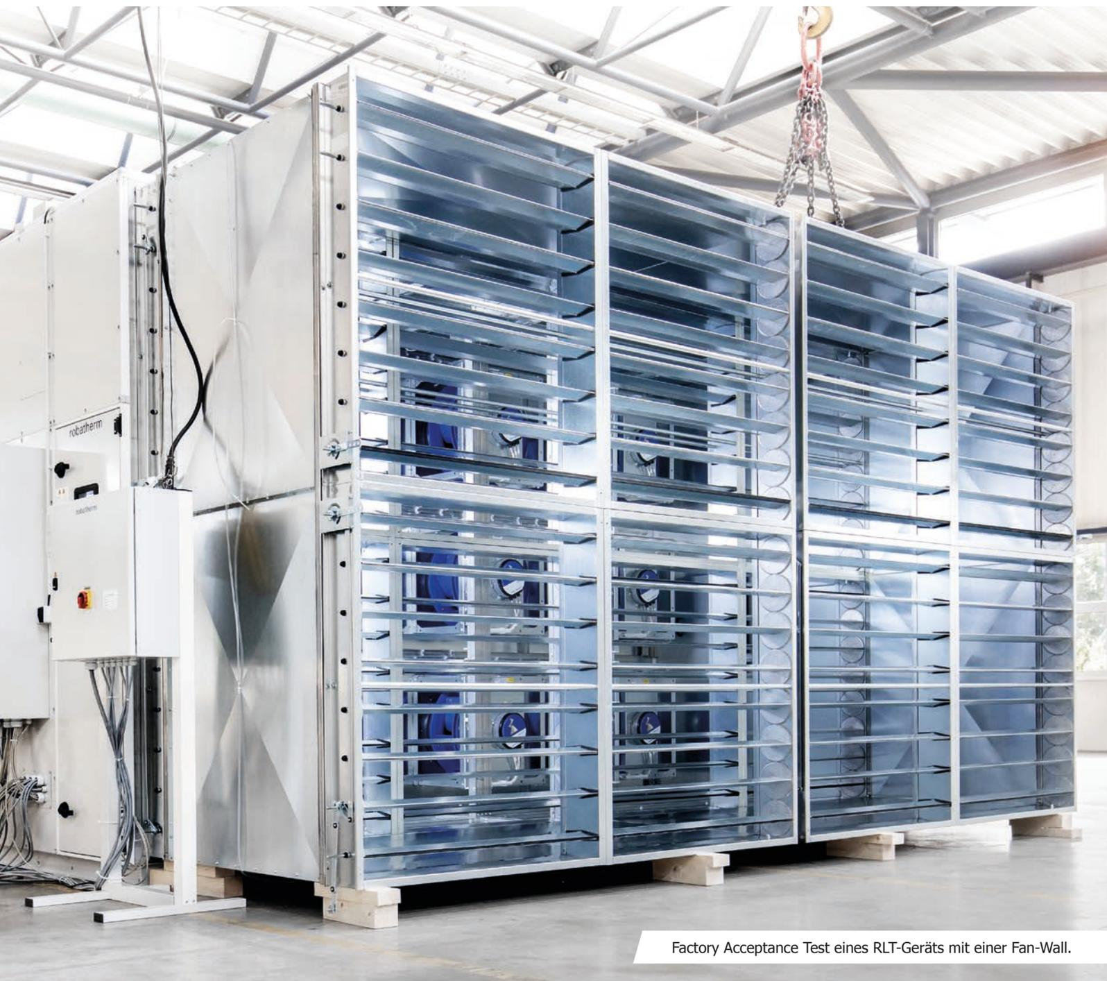
Factory Acceptance Test eines RLT-Geräts mit einer Fan-Wall.
