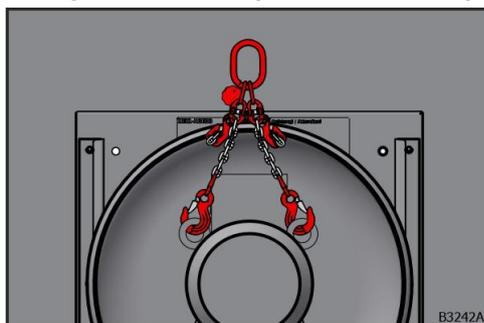
Abb. 31: Einhängen der Anschlagketten bei zwei Anschlagösen
