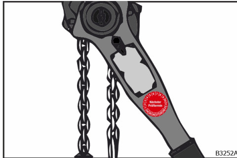
Ilustr. 105: plakietka kontroli (wciągnik łańcuchowy z dźwignią)
