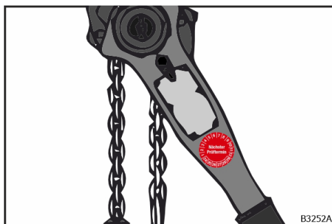
Ilustr. 48: plakietka kontroli (wciągnik łańcuchowy z dźwignią)
