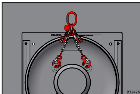
Ilustr. 80: zawieszenie łańcuchów oporowych w przypadku dwóch zaczepów mocujących
