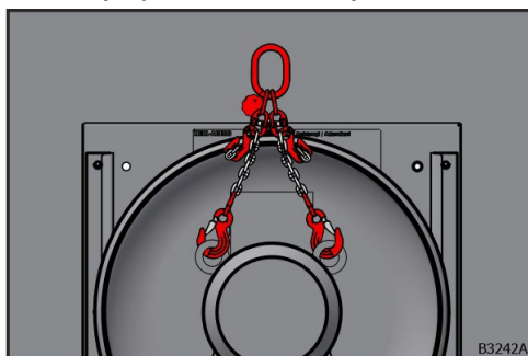
Obr. 83: Zavesenie viazacích reťazí pri dvoch viazacích okách
