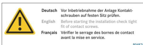
Fig. 4: Panou de avertizare „Verificați șuruburile de contact”
