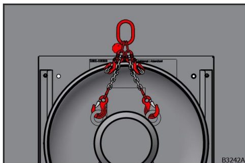
Obr. 24: Zavěšení vázacích řetězů v případě dvou vázacích ok
