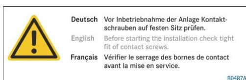
Obr. 4: Výstražná značka „Zkontrolujte kontaktní šrouby“
