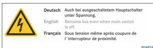
Obr. 2: Výstražná značka „Vypnutý hlavní vypínač“
