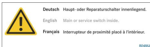
Fig. 3 : Panneau d'avertissement « Interrupteur de proximité »
