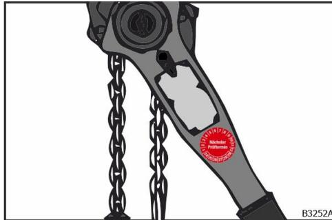
Fig. 105 : Plaque de contrôle (palan à chaîne à levier)
