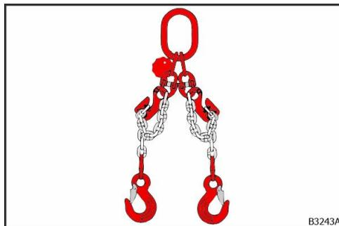
Fig. 82 : utilisation des crochets de raccourcissement de la chaîne
